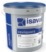
☰ Mortero acrílico mineral de grano homogéneo para la impermeabilización y decoración de fachadas e interiores. Aplicación a llana o pistola de pastas densas. Acabado fratasado, gota, gota chafada. No cuartea en capa gruesa. Con conservante antimoho (para película).
