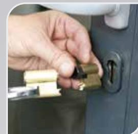
... el cuerpo del cilindro se parte por el centro, facilitando el acceso del atacante.
